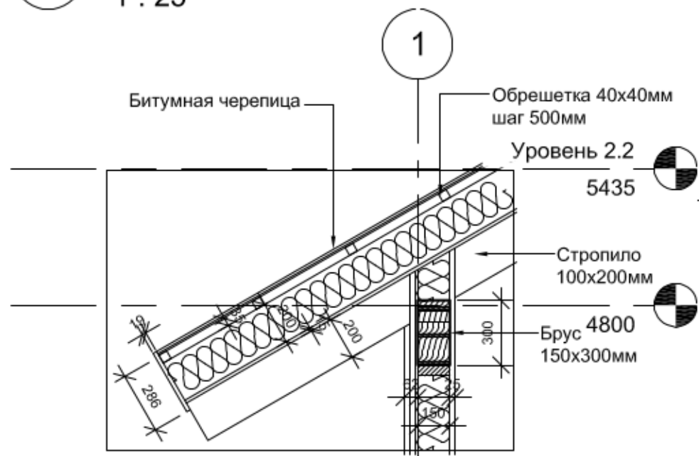
4 Деталь кровли 1 : 25
